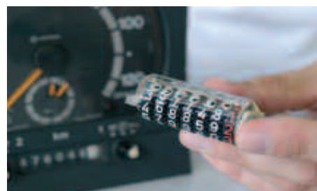
Een geveilde schakelaar of afgebroken 'verzegelde' stukken om de tachograaf uit te schakelen... Gaatjes in de kilometerteller om de stand terug te draaien...
