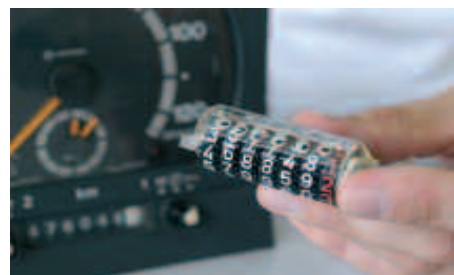
Un interrupteur scié ou des pièces cassées pour éliminer le tachygraphe. De petits trous dans le compteur pour faire baisser le nombre de km.
