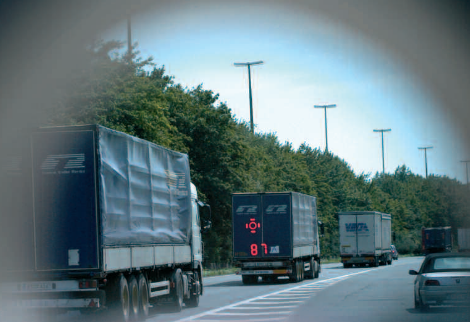
A l'aide des jumelles laser, la vitesse du camion du milieu est mesurée à 87km/h.
